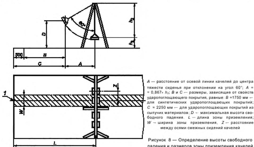
Рисунок 8 — Определение высоты свободного падения и размеров зоны приземления качелей
